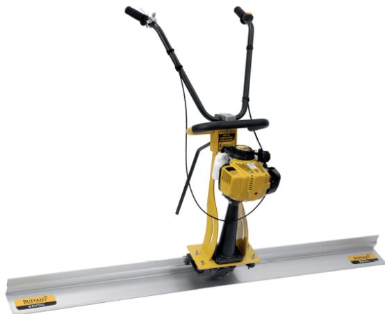
A Régua Vibratória BFG2.4 é um equipamento a gasolina 4 tempos, refrigerado a ar, indicado para nivelamento e compactação superficial de concreto em grandes áreas. Seu design permite operação eficiente e controle preciso do acabamento.
