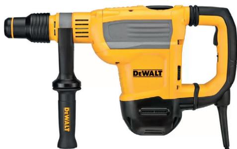
O martetele perfurador D25810KB2 é leve e versátil, com peso aproximado de 6 kg e energia de impacto de 7,1 J. Conta com sistema SDS-MAX, motor de 1050 W e tecnologia antivibração SHOCKS, sendo indicado para perfuração e remoções leves em concreto e alvenaria.
