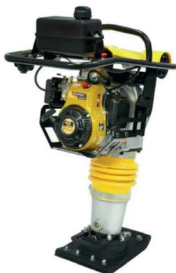
O compactador de terra Buffalo BFG75B é ideal para operações em obras de pavimentação, fundações, valas e compactações em áreas confinadas. Equipado com motor a gasolina 4T de 4,0 cv, oferece força de impacto de 14 kN e curso de percussão ajustável entre 40 e 80 mm. Compacto, robusto e de fácil manutenção, entrega excelente desempenho em qualquer tipo de solo.
