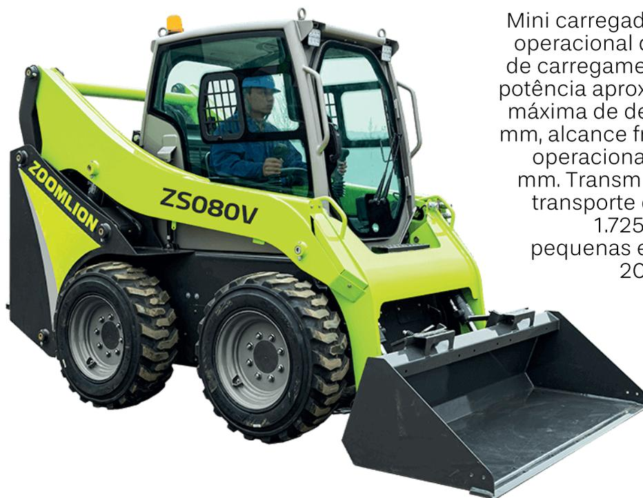
Mini carregadeira skid-ster com peso operacional de 2.850 kg e capacidade de carregamento de 0,4 m<sup>3</sup>. Motor com potência aproximada de 36,5 kW. Altura máxima de descarga de cerca de 2.377 mm, alcance frontal de 790 mm e curso operacional em terreno de até 3.826 mm. Transmissão hidráulica, altura de transporte de 1.998 mm e largura de 1.725 mm. Indicada para obras pequenas e aplicações com mais de 200 acessórios disponíveis.
